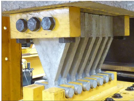
Figura 3.58 Disipadores TADAS dispuestos en paralelo [100]
