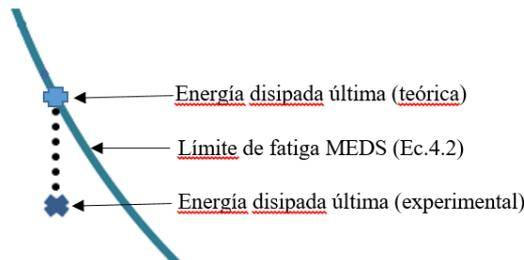
Figura 4.14 Representación de la fatiga a bajo número de ciclos del MEDS. Modelo Benavent Climent
