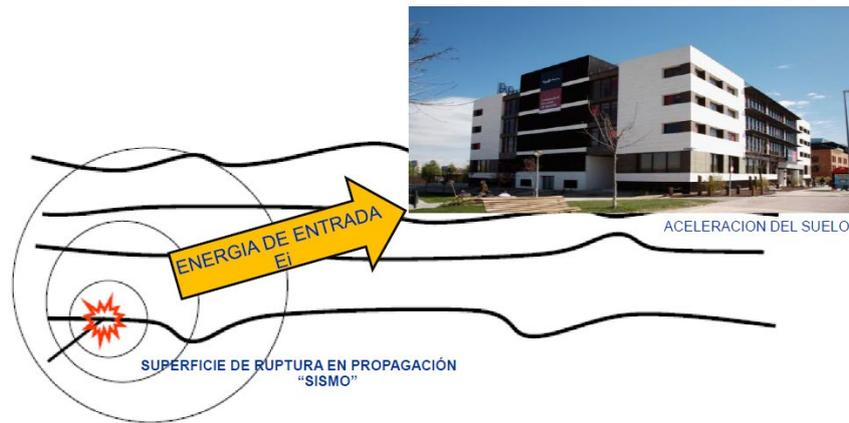
Figura 2.1 El diseño convencional sugiere que la propia estructura es la responsable de disipar la energía sísmica [23]
