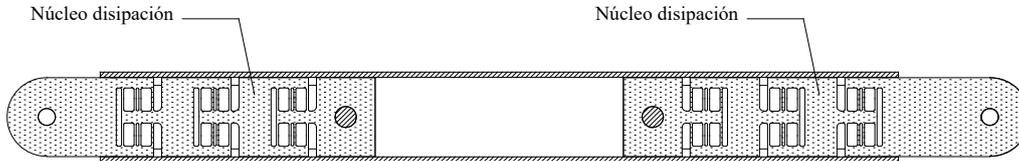
Figura 5.18 Brazo de disipación MEDS con dos núcleos de disipación
