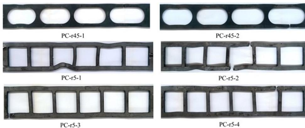
Figura 3.56 Núcleos de disipación dañados de los PCBRB (segmentos exteriores están a la izquierda)
