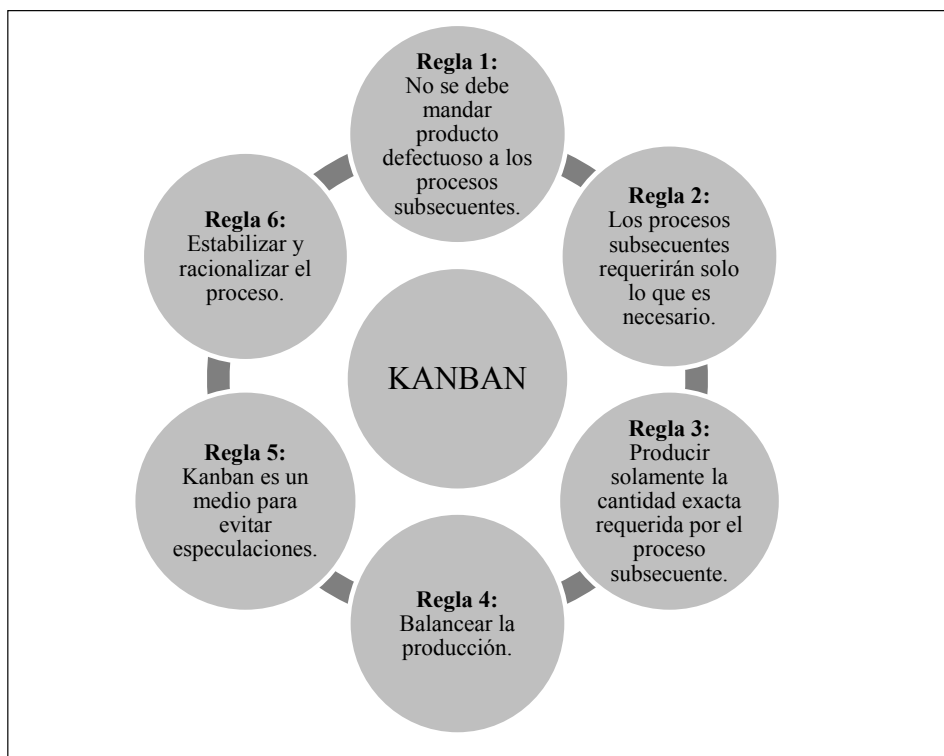
Figura 1. Reglas en las que se basa la metodología Kanban Fuente: elaboración propia
