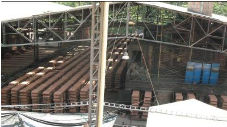
Foto 12. Secado de ladrillo verde
