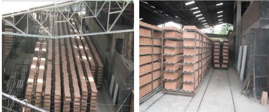
Foto 10 y 11. Secado de ladrillo verde
