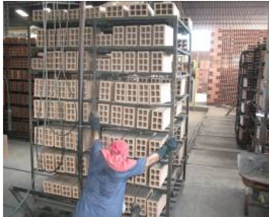
Foto 15. Cargue de vagonetas
