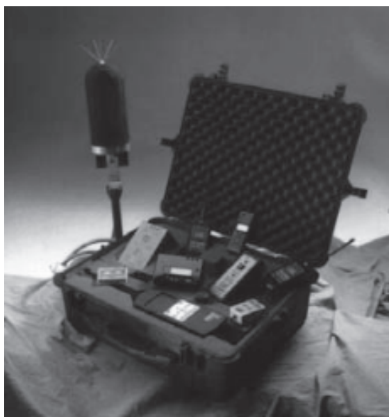
Figura 5. Kit de monitoreo de ruido realzado.
