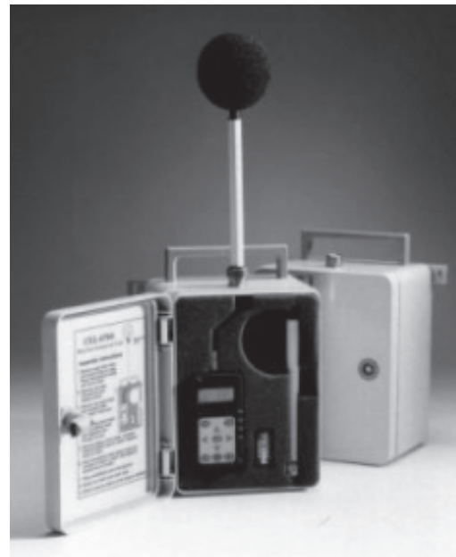
Figura 3. Kit de monitoreo de ruido simple.
