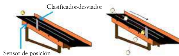
Figura 4. Clasificador electromecánico de mangos.
