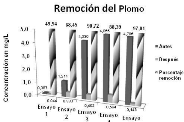
Figura 4. Eficiencia de la batería de filtros en la remoción del plomo
