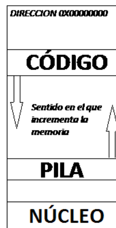
Figura 1. Espacio virtual de direcciones de los procesos, en sistemas GNU/Linux
