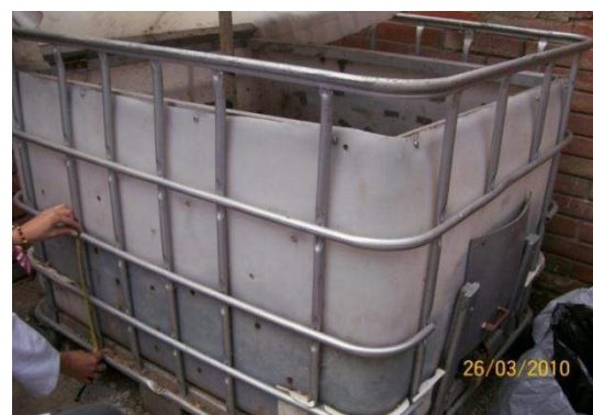
Figura 1. Contenedor utilizado para el biorreactor
