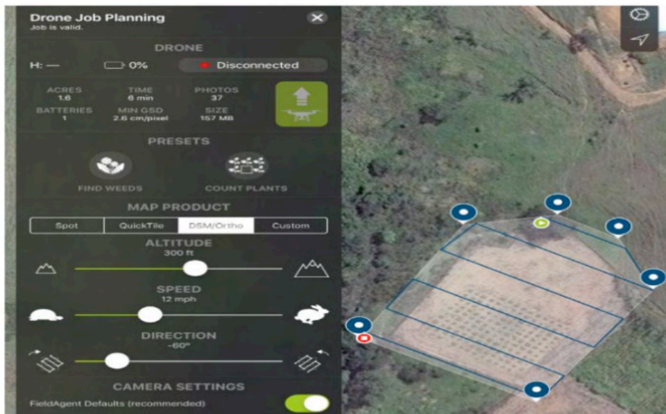
Figura 1 – Etapa de planejamento do voo com VANT na área experimental e visualização do ambiente de configuração.
