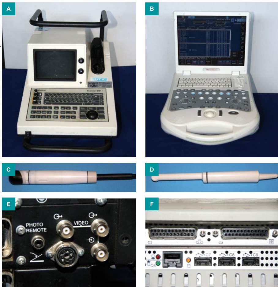
Figura 1. Evolução tecnológica em equipamentos de ultrassonografia, representada por equipamentos de duas gerações (1998 e 2008): Scanner 200, Pie-Medical e Holanda (A, C, E); MyLab 30, Esaote e Itália (B, D, F); design, layout, tipo e tamanho do monitor (A, B); probes (setorial mecânica vs. microconvexa eletrônica) (C, D); portas de saída (vídeo vs. USB/Ethernet) (E, F).
