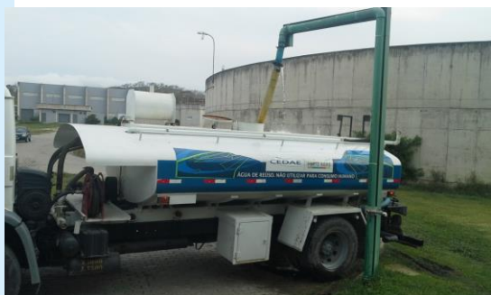
Figura 5: Abastecimento do caminhão pipa com água de reúso na ETE Alegria no Rio de Janeiro
