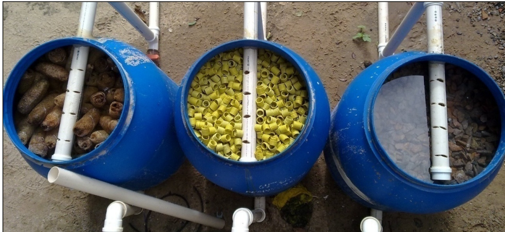
Figura 3: Filtros preenchidos com bucha vegetal (esquerda), eletroduto corrugado (centro) e pedra britada (direita).
