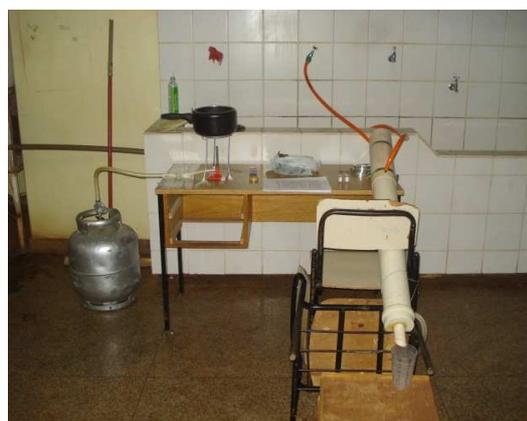
Figura 5: O Condensador sendo aquecido para o recolhimento do material extraído.
