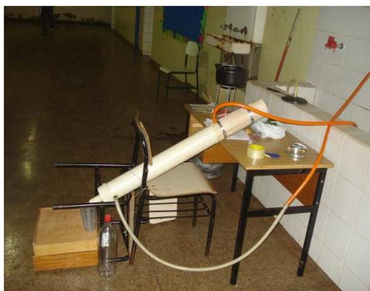
Figura 4: A introdução da água é pela parte inferior do cano, ligada na torneira.
