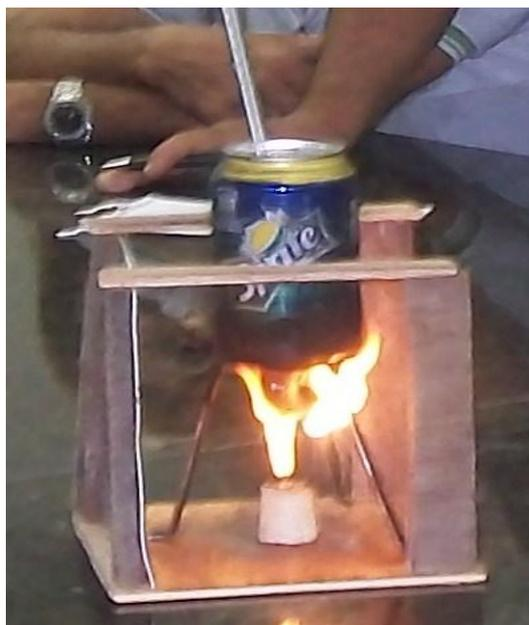
Figura 1: Calorímetro Alternativo.
