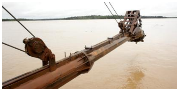
Figura 2: Lança de sucção, responsável por revolver o sedimento e bombear a mistura de água e areia do fundo leito para a draga.
