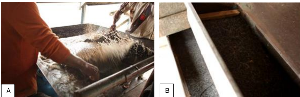
Figura 5: Processo de batida dos carpetes na mesa resumidora para a retirada do ouro retido (A). Canaletas menores revestidas com carpete para a concentração do ouro após a batida inicial (B).
