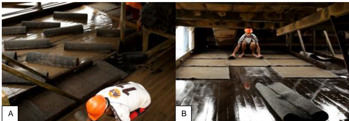
Figura 4: Garimpeiro recolhendo e enrolando os carpetes utilizados para a retenção do ouro (A) e disposto os novos carpetes para reiniciar o processo de bombeamento (B).
