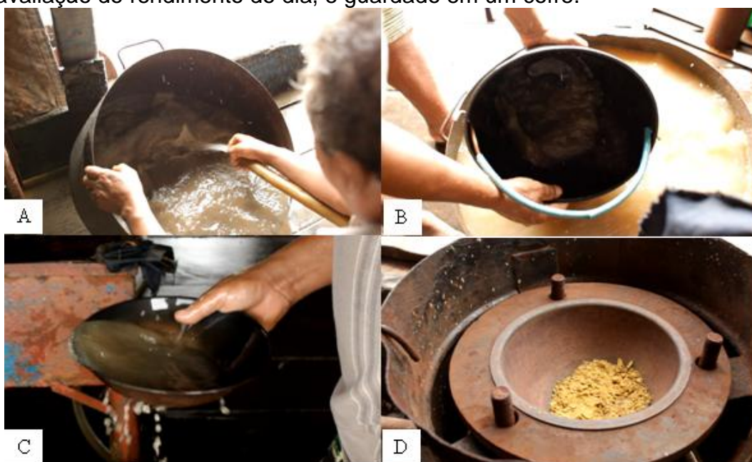
Figura 7: Fases de bateamento (A: em tambor; B: em um balde; C: em uma cuia) para redução da quantidade de água e eliminação da areia junto ao ouro, que é purificado ao fim do processo (D).
