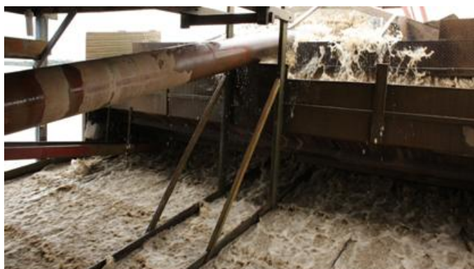
Figura 3: Água passando pelo gradeamento (parte superior) e escorrendo pela caixa com os carpetes (parte inferior).
