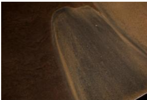
Figura 6: Ouro extraído visto durante a batida dos carpetes na mesa resumidora.
