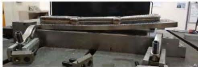
Figure 1.30 – Distorsion de structure réalisée par le WAAM [Xu+2018]
