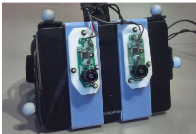
FIGURE 2.1 – Un prototype de VST-HMD issue des travaux de [Steptoe 2014], comprenant un casque de réalité virtuelle et deux caméras.
