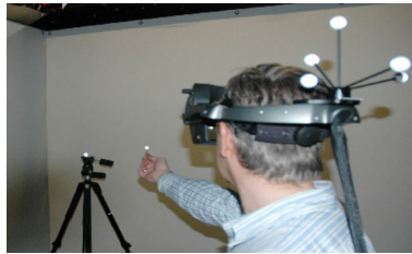
FIGURE 2.33 – Exemple d’alignement effectué lors de l’étalonnage proposé par [Kellner 2012]. L’utilisateur se déplace dans la scène de manière à superposer le marqueur posé sur le trépied, celui tenu à la main et le point 2D affiché par le casque. (Extrait de [Kellner 2012])
