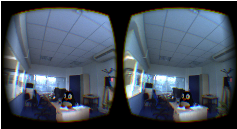
FIGURE 4.8 – Images stéréoscopiques affichées sur l'écran du VST-HMD incluant la projection d'un modèle synthétique de pingouin sur la surface d'un bureau.
