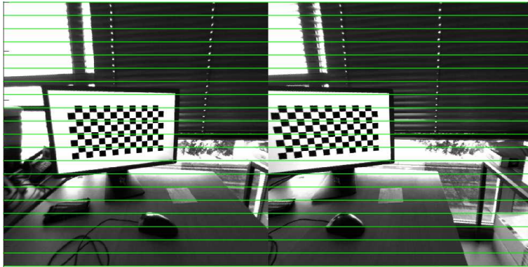
FIGURE 2.10 – Exemple d’images rectifiées issues d’un banc stéréoscopique. Les lignes vertes représentent des lignes épipolaires.
