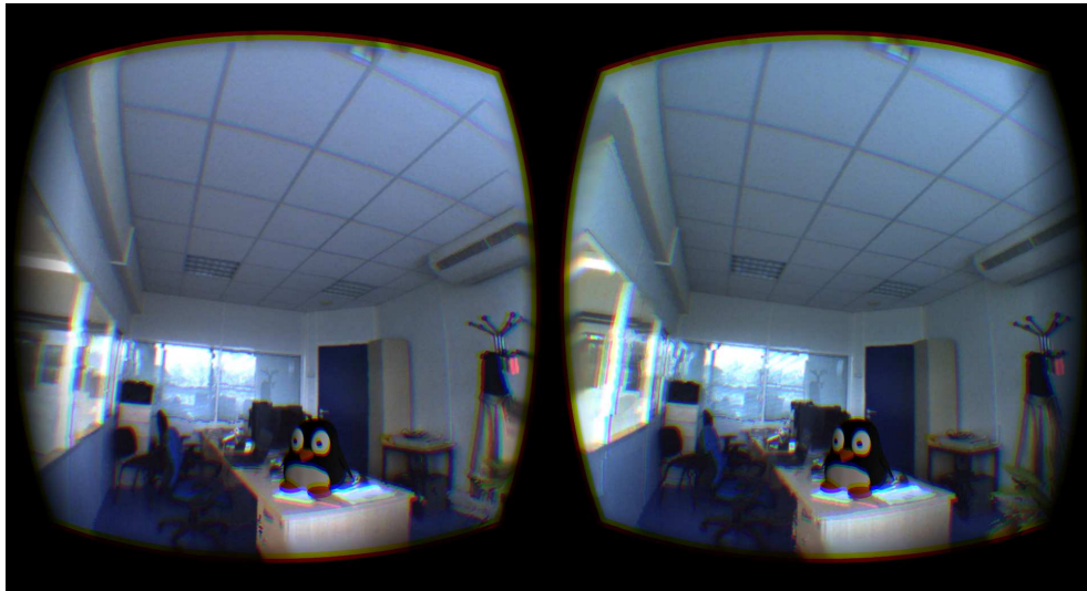
FIGURE 4.15 – Images stéréoscopiques affichées sur l’écran du VST-HMD pour l’application d’exemple. Un modèle synthétique de pingouin est projeté sur la surface d’un bureau dans la direction du regard de l’utilisateur.
