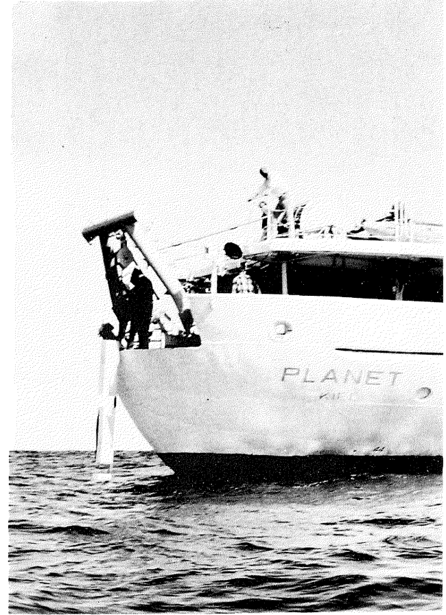
Abb. 7: Aussetzen des Schleppkabels
