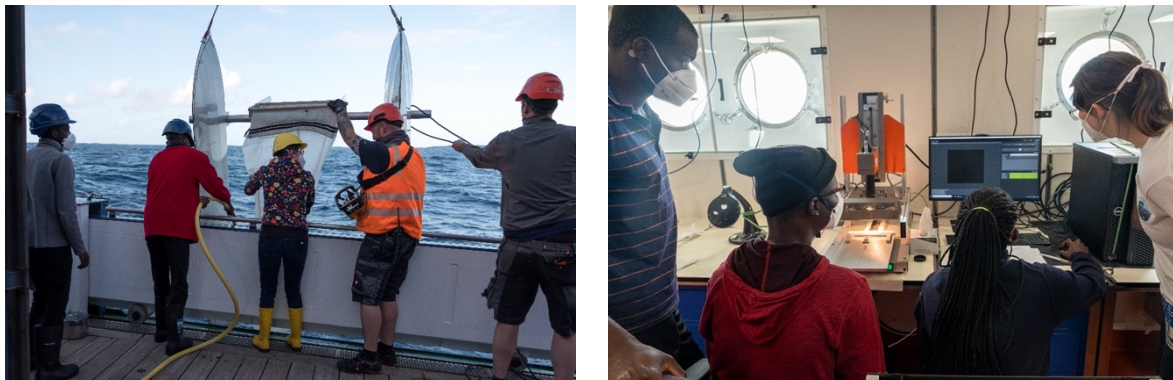
Abbildung 2, (S. Kaehlert): Einholen des Katamarans und Waschen der Probe in das „cod-end“ am Ende des Netzbeutel (links). Das „cod-end“ wird ausgetauscht und der Katamaran direkt wieder ausgesetzt. Gnilane Diouf aus dem Senegal bereitet die Mikroplastik Partikel für das Scannen mit der Hyperspektral-Kamera vor (rechts). Dieses bildgebende System erlaubt es bereits an Bord zu analysieren, ob es sich bei den auf der Oberfläche gefundenen Partikeln tatsächlich um Mikroplastikpartikel handelt.
