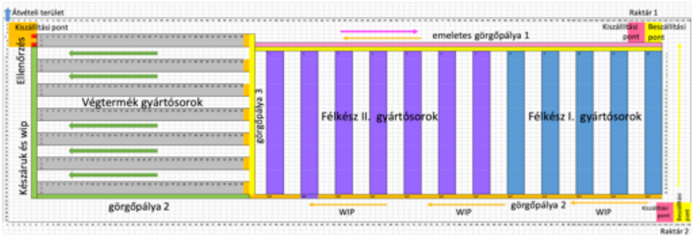
7. ábra: A jövőállapot VSM szerint kialakított új üzemelrendezés Forrás: saját szerkesztés a fejlesztés alapján (2020)
