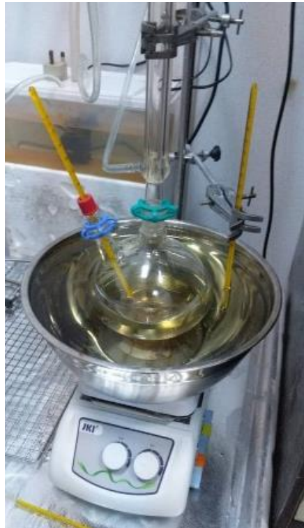
Rajah 5 Proses transesterifikasi bagi minyak bunga matahari
