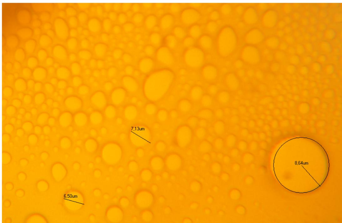
Figura 11. Microfotografía de la emulsión de metanol en aceite.
