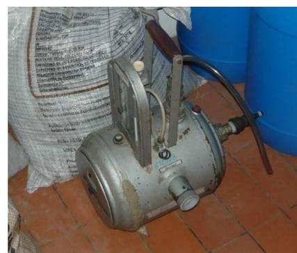
Figura G-9. Medidor húmedo de gases
