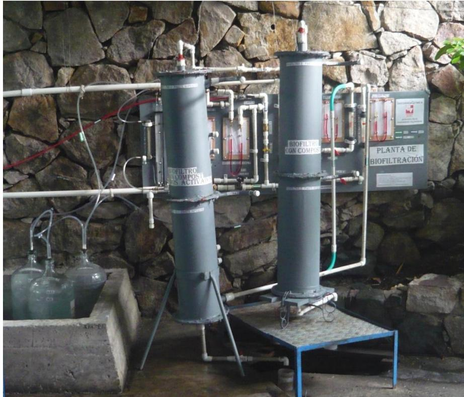
Figura G-1. Planta piloto para la biofiltración de vapores de alcohol isoamílico.
