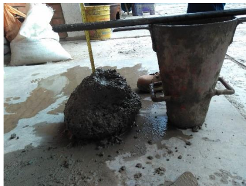
Figura 12. Asentamiento de concreto con agregados con pretratamiento
