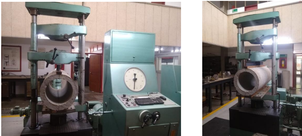
Figura 16. Montaje del ensayo de aplastamiento
