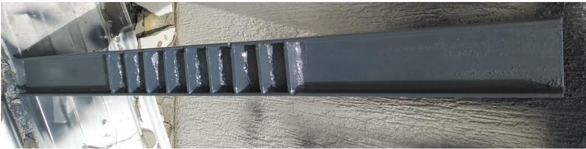
Figura 15. Soporte Superior, viga IPE80
