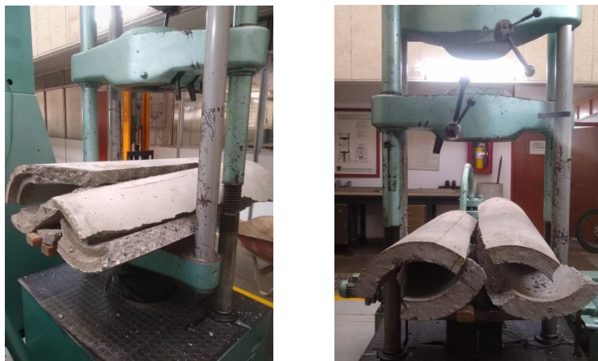
Figura 17. Falla súbita en tubería de concreto.
