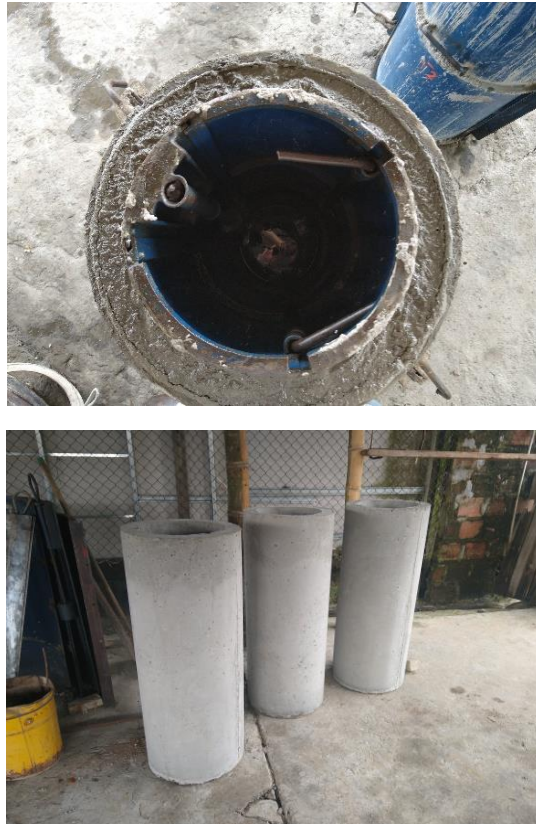
Figura 14. Tubos de concreto: concreto fresco (superior), concreto endurecido (inferior).
