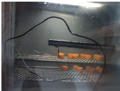
Figura 4. Muestras de melón en el IQF en bandejas con flujo paralelo
