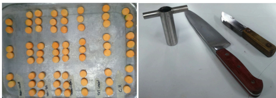
Figura 2. Sacabocados, cuchillo y cuchillo con doble corte utilizado para el acondicionamiento de las muestras de melón
