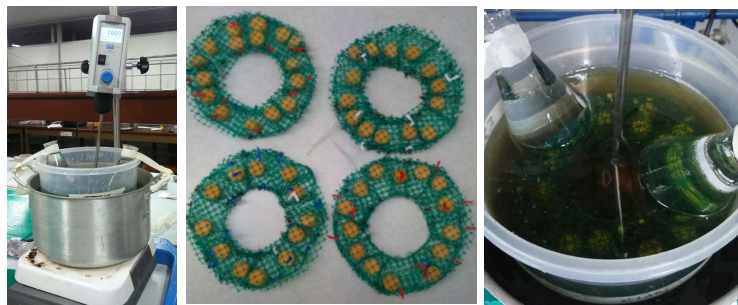
Figura 3. Montaje del proceso de la deshidratación osmótica de melón con el agitador mecánico y las canastillas con muestras en su interior
