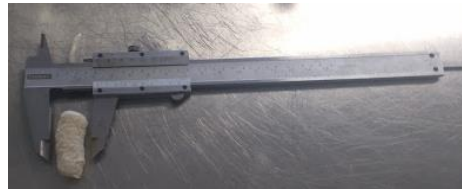
Figura 10. Pie de rey utilizado para la determinación del diámetro del pasaboca producido por el extrusor.
