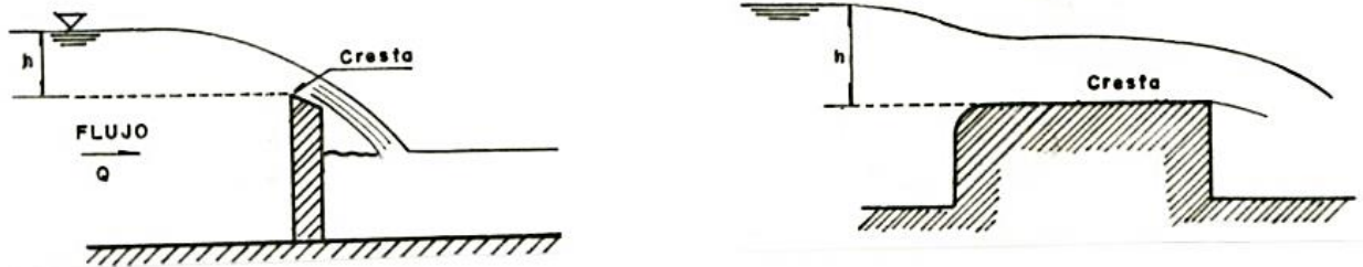
Figura 5. Partidores de vertedero. Fuente: MANUAL DE PRÁCTICAS DE LABORATORIO DE HIDRÁULICA. (p. 1), por Pérez, R.
