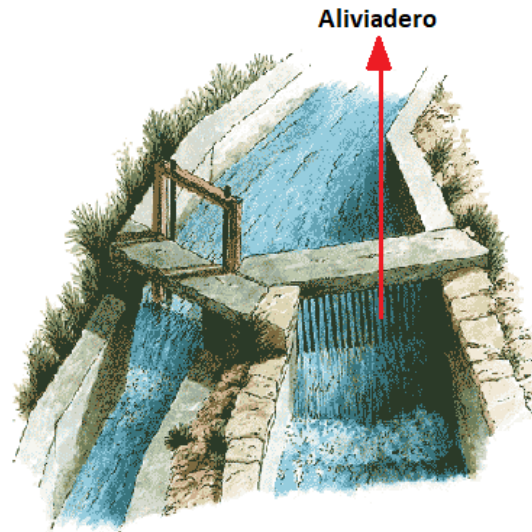
Figura 6. Aliviadero que funciona como partidor. Fuente: Murcia y el agua: Historia de una pasión (cap. 6), por Vera, N. (2005).
