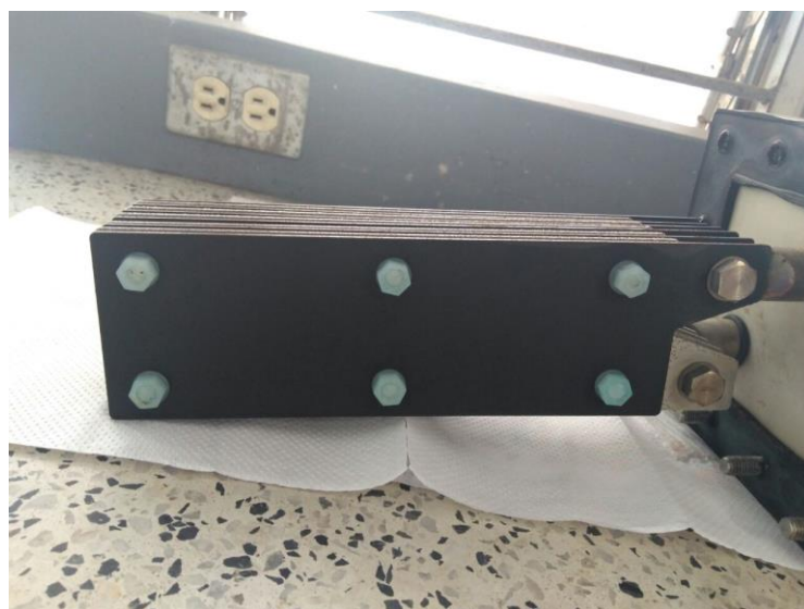
Figura 11. Estado del arreglo de electrodos al finalizar las pruebas
