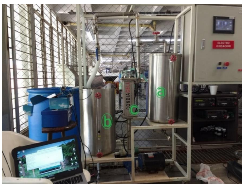
Figura 2. Equipo de planta piloto: (a) tanque de almacenamiento; (b) tanque de recirculación; (c) reactor.
