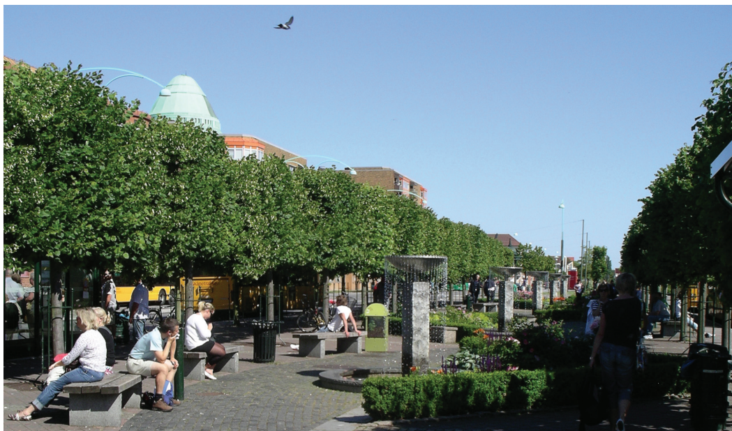
Ljud från vegetation och vatten bidrar till en positiv upplevelse i staden – fontänerna på bilden maskerar dessutom buller från omgivande trafik. Vatten och vegetation är också viktiga byggstenar i biotoper som kan locka sjungande fåglar. Bilden visar Södervärns busstation, utformad av Gatukontoret, Malmö stad.
