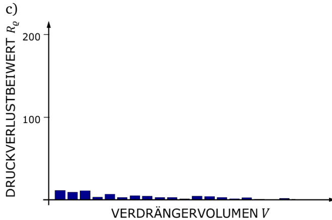
Abbildung 6: Darstellung von R_q über die Maschinengröße für a) Exzentrerschnecken- b) Zahnrad- und c) 2-spindlige Schraubepumpen.
