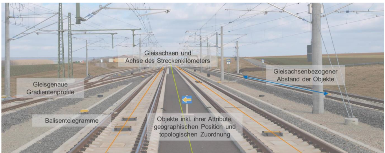
Abb. 2 Übersicht der Bestandteile eines SATengine-Infrastrukturdatensatzes
