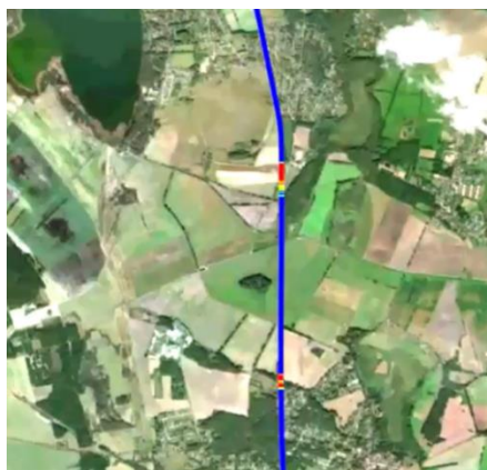
Abb. 6 Echtzeitdarstellung der akustischen Energie zweier Züge mit hinterlegter Landkarte.
