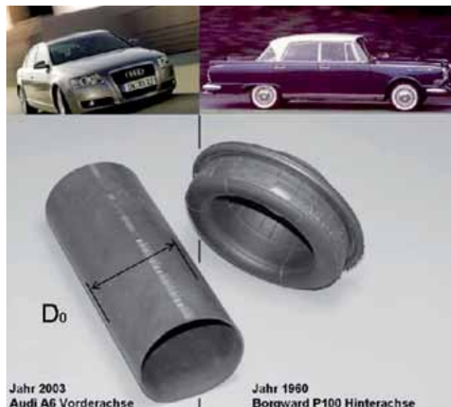
Bild 1. Gegenüberstellung Vibracoustic-Luftfederschlauch mit 1,6 mm Wanddicke gegenüber dem Phoenix-Elastomerformteil aus dem Jahr 1960 mit einer Wandstärke > 4 mm
