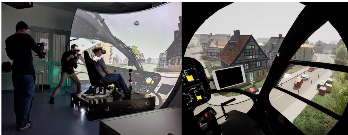
Abbildung 5: Helikopter-Simulator (XR-Sim) am Institut für Flugführung während der Dreharbeiten (links). Sicht des Piloten durch die XR-Brille Varjo XR-3 kurz vor der Landung neben der Unfallstelle (rechts).
