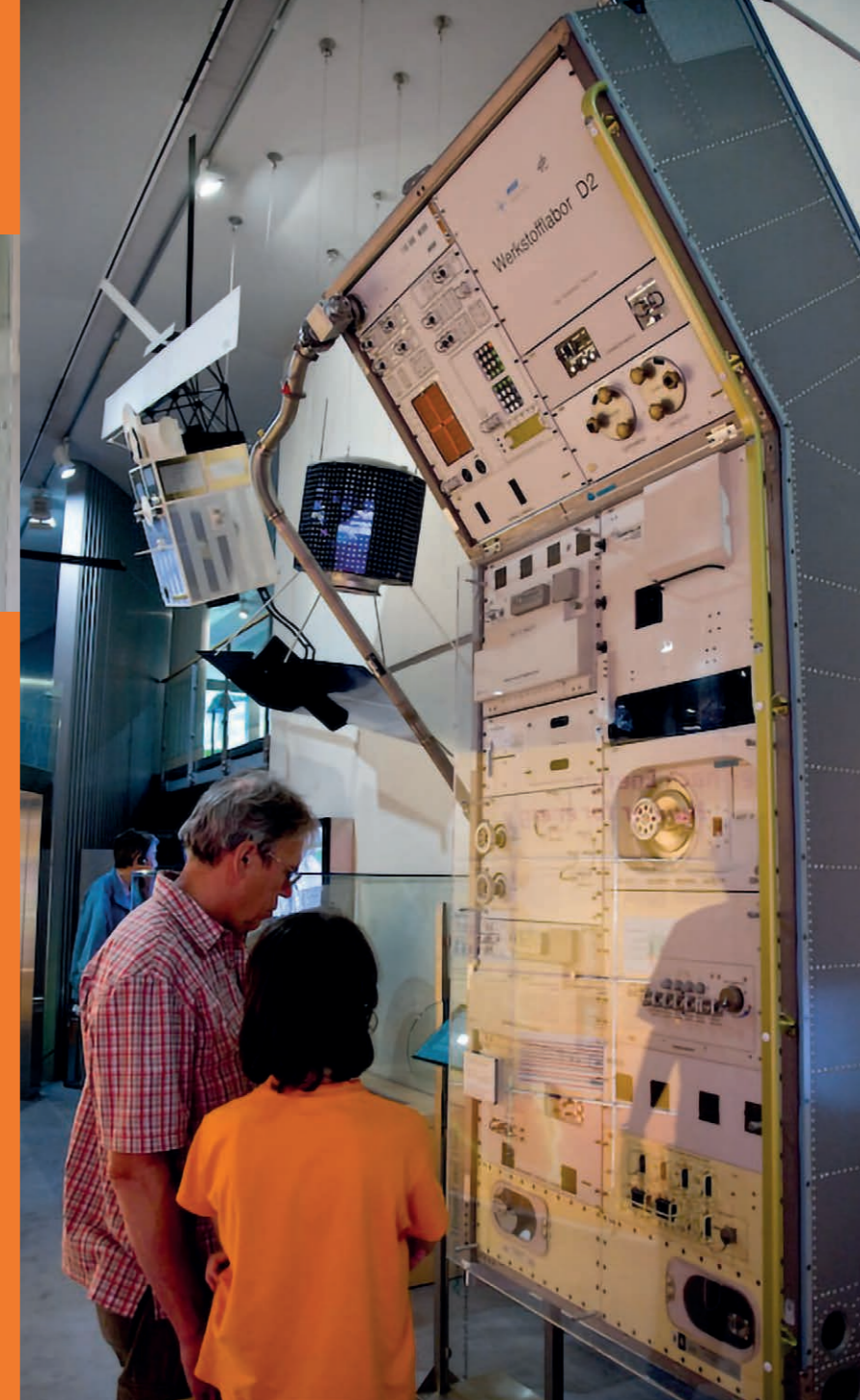
Im Werkstofflabor des Weltraummoduls Spacelab führten die Astronauten wissenschaftliche Experimente auf den Gebieten Metallforschung, Flüssigkeitsphysik und Kristallforschung in Schwerelosigkeit durch
