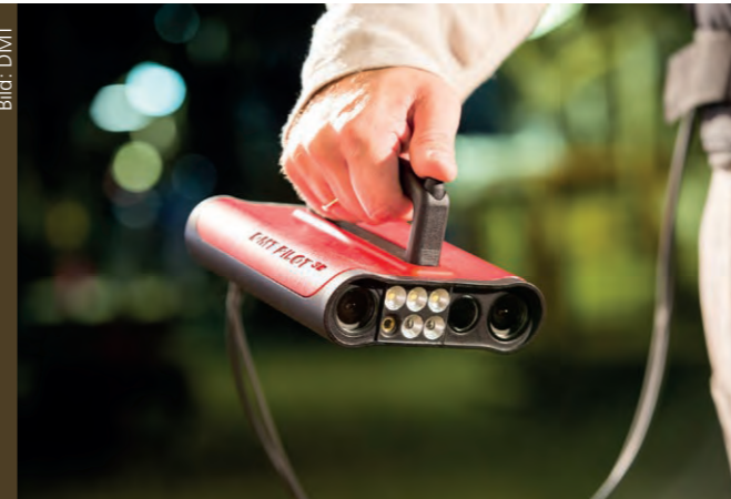
Das vom DLR entwickelte Integrated Positioning System (IPS) besteht aus einem Stereokamerasystem (links und rechts außen) sowie einem eingebauten Inertial-Messsystem. Eine zusätzliche Kamera (zweite Öffnung von rechts) erstellt das Inspektionsfoto. In der Mitte befinden sich LEDs zur Beleuchtung der Szenerie.
