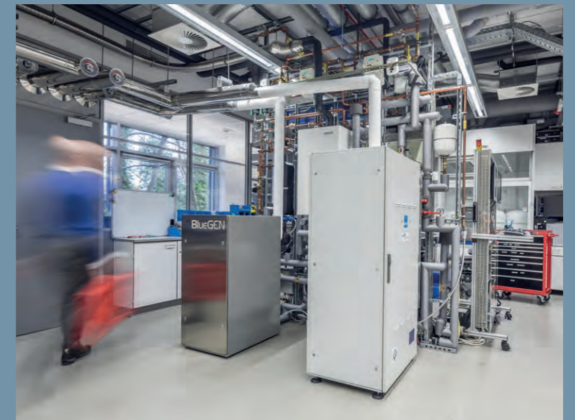
„Wärme zu speichern ist viel billiger, als Strom zu speichern“, betont Carsten Agert. Vor diesem Hintergrund erforscht das DLR in seinem KWK-Labor (Kraft-Wärme-Kopplung) strombasierte, mit Wärmespeicherung gekoppelte Heizungssysteme. Wird die Wärme zu dem Zeitpunkt erzeugt, zu dem Strom im Überfluss vorhanden ist, bringen sie mehr Flexibilität ins Energiesystem.
