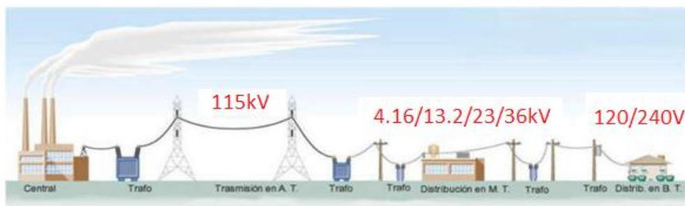
Figura 11: Esquema del sistema eléctrico de potencia de El Salvador. Fuente: Elaboración propia.
