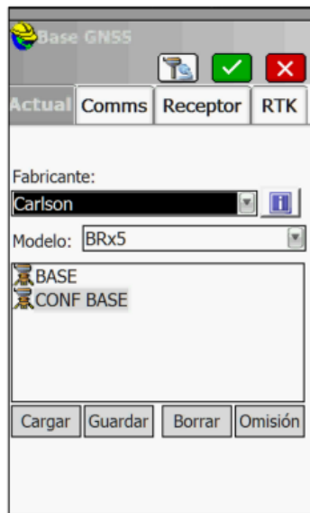
Figura 21 Enlazando el aparato receptor base con la colectora de datos
