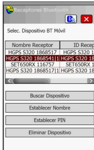
Figura 25 Enlazando el aparato receptor base con la colectora de datos
