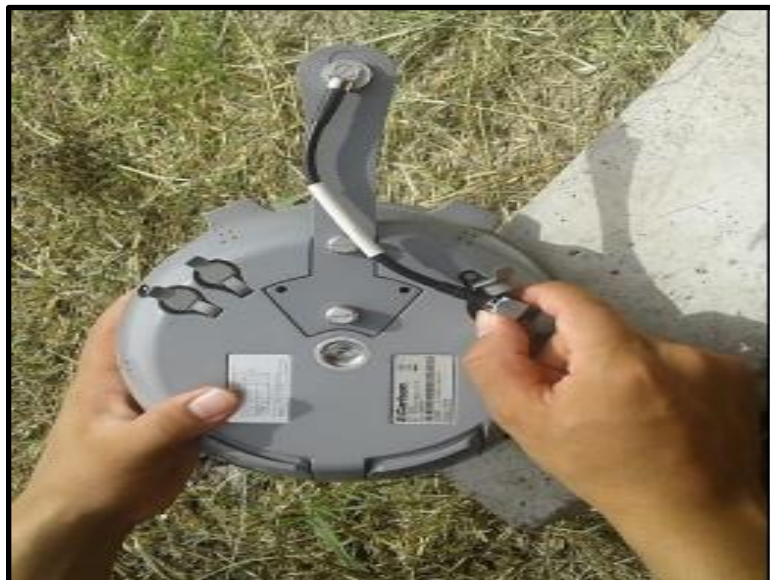
Figura 17 Instalación de antena al Rover y la base
