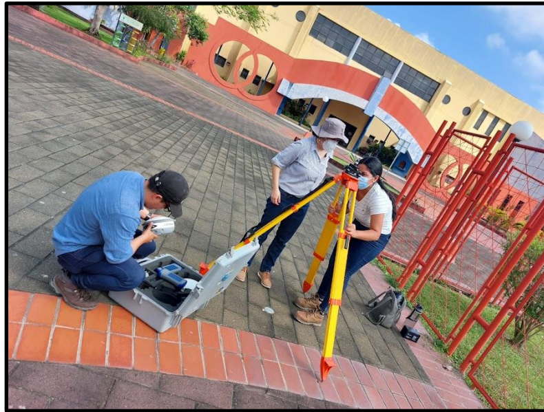
Figura 16 Instalación del equipo que se dejara como receptor base
