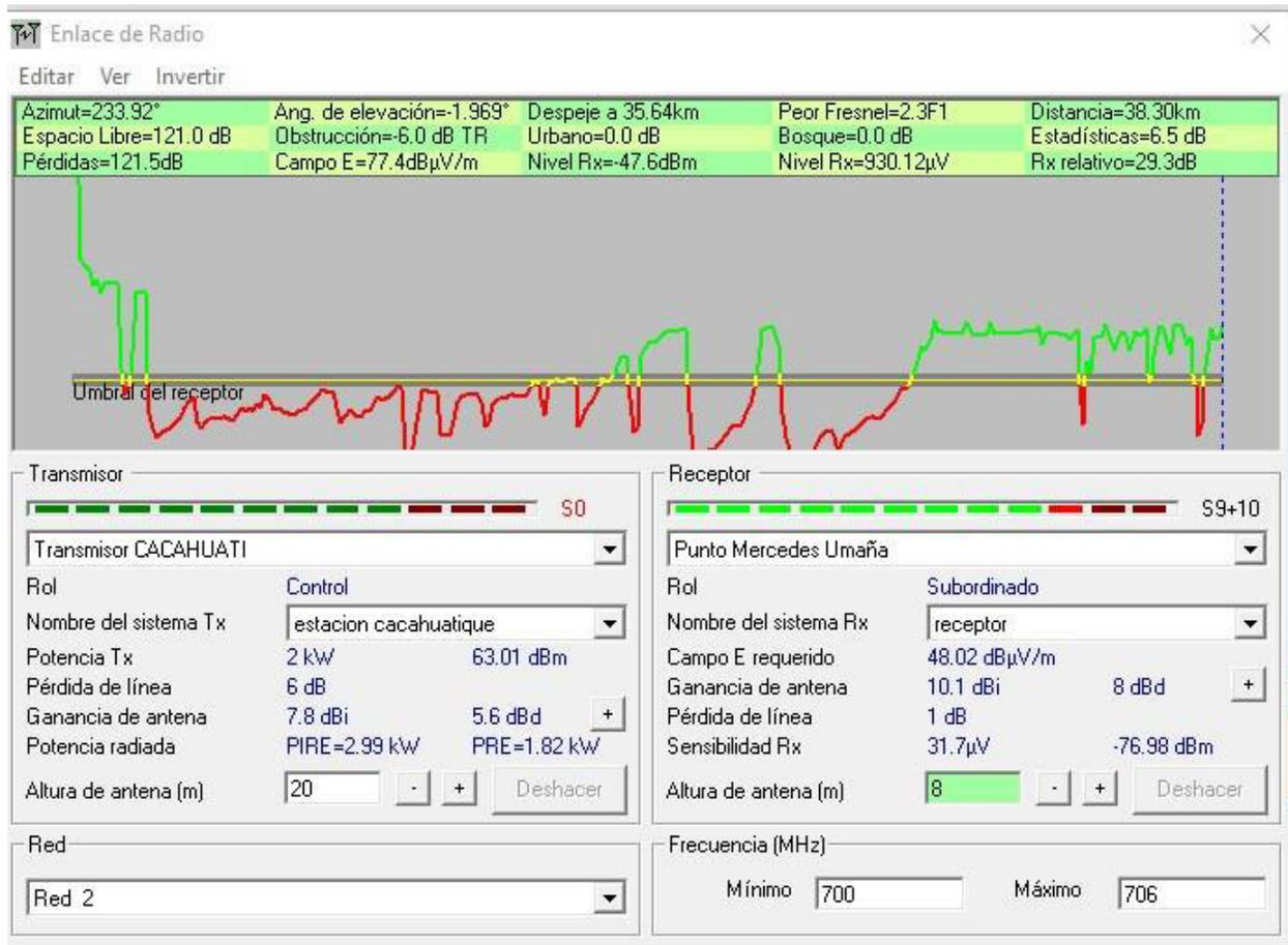
Figura 72: Enlace de radio Radiomobile (Ayala M, 2021)
