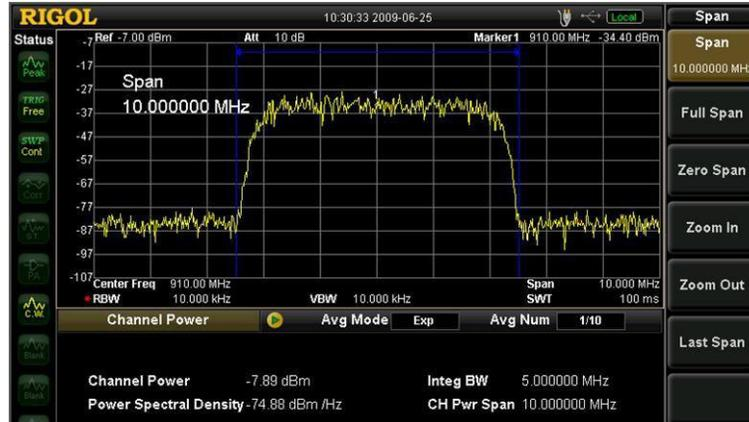
Figura 13. Anchura de banda ocupada. (Rigol s.f.)
