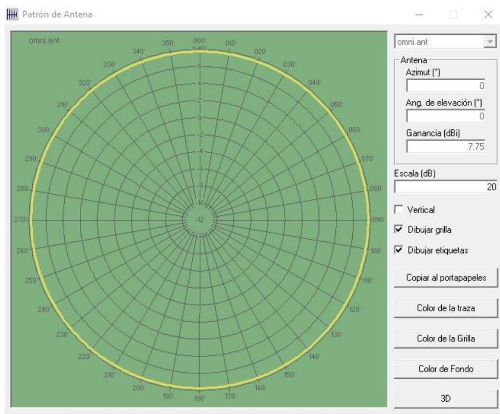
Figura 48: Patrón de antena del transmisor. (Ayala M, 2021)
