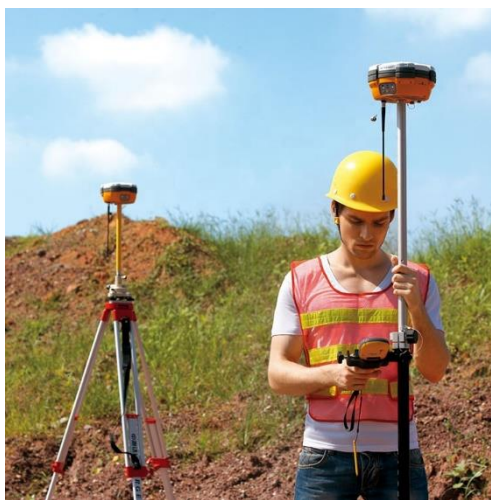
Figura 3.1.1 Medición por el método RTK.
