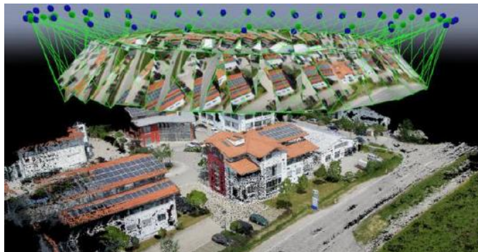
Figura 2.3.15 Reconstrucción 3D. Fundación de la energía de la comunidad de Madrid (2015). "Los Drones y sus Aplicaciones en la ingeniería Civil"
