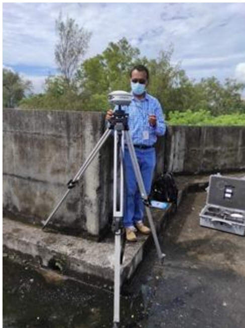
Figura 3.1.3 Receptor GPS Acoplado y Correctamente Nivelado. Fuente: Propia.
