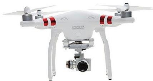
Figura 2.3.8 Ala Rotatoria. Fundación de la energía de la comunidad de Madrid (2015). "Los Drones y sus Aplicaciones en la ingeniería Civil"
