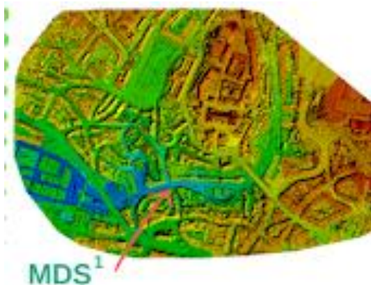
Figura 2.4.1 Modelo digital de superficie (MDS) Serch Jiménez. (2020). Modelos digitales de superficie y de terreno obtenidos con drones..
