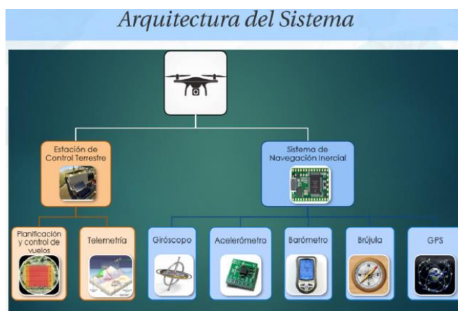
Figura 2.3.19 Arquitectura del sistema del dron. Fundación de la energía de la comunidad de Madrid (2015). "Los Drones y sus Aplicaciones en la ingeniería Civil"
