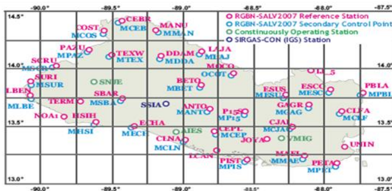
Fig. 1. National reference frame of El Salvador (Red Geodésica Básica Nacional de El Salvador, SIRGAS-ES2007.8)
