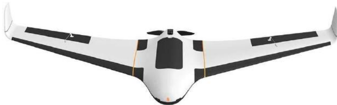
Figura 2.3.7 Drone de ala fija. Fundación de la energía de la comunidad de Madrid (2015). "Los Drones y sus Aplicaciones en la ingeniería Civil"
