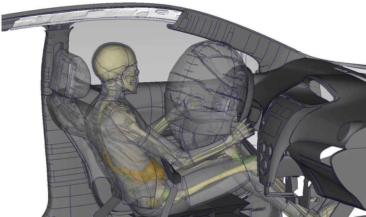
Abbildung 70: Simulationsmodell des SENIORS-Rückhaltesystems und Sitz mit THUMS v4 und Toyota Yaris Interieur (Windschutzscheibe ausgeblendet)
