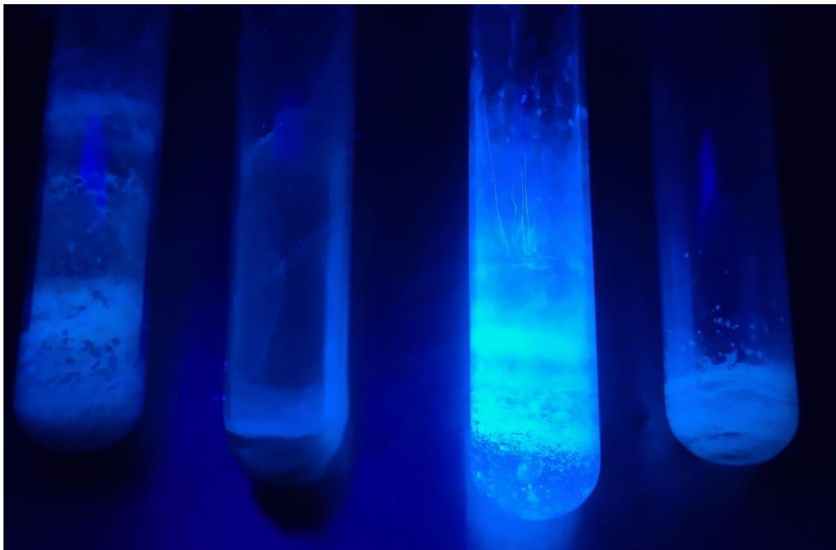
Abbildung 156: Festkörperfluoreszenz der Eisenkomplexe mit einem perphenylierten Cyclopentadienylring bei der parallelen Anregung; Reihenfolge von links: 95 (Me), 96 ( i Pr), 97 (Ph) und 98 ( n Bu).
