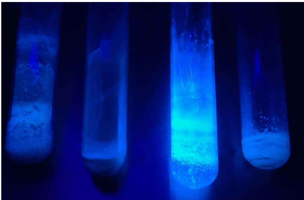
Abbildung 172: Festkörperfluoreszenz der Eisenkomplexe mit einem perphenylierten Cyclopentadienylring; Reihenfolge von links: 95 (Me), 96 ( i Pr), 97 (Ph) und 98 ( n Bu).
