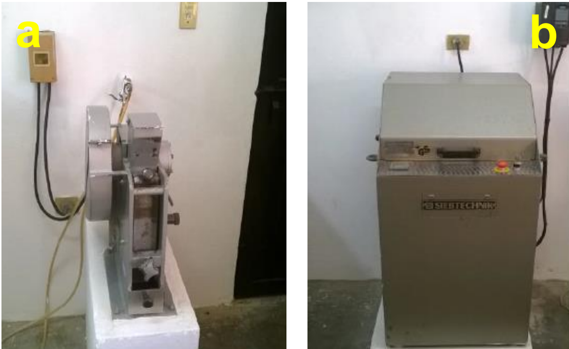
Figura 3.6: (a) Triturador Siebtechnik EB 7/6 y (b) molino de ágata Siebtechnik Ts 100 A del laboratorio de molienda de la Facultad de Ciencias de la Tierra - UANL.
