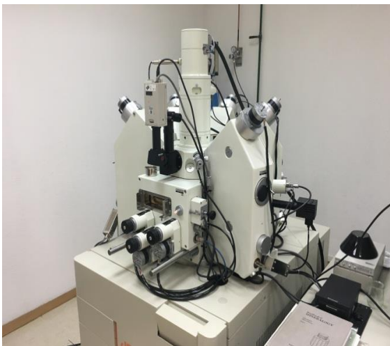
Figura 3.8: Microsonda Electrónica WDS JEOL JXA-8900, Centro Nacional de Microscopía Electrónica (Madrid, España).
