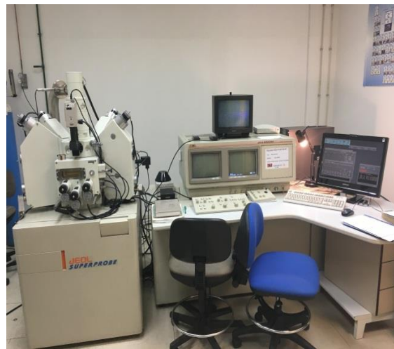
Figura 3.8: Microsonda Electrónica WDS JEOL JXA-8900, Centro Nacional de Microscopía Electrónica (Madrid, España).
