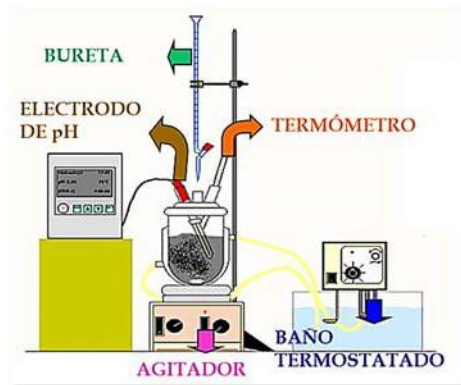
Figura 4.21. Dispositivo experimental para la hidrólisis enzimática
