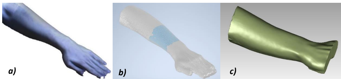
Figura 8. Modelo digital del brazo (a) modelo limpio sobre el que trabajar (b) y sólido con offset inicio del diseño de la férula (c)
