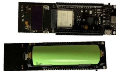
Figura 25. ESP32 TTGO OLED and battery board. Fuente: Elaboración propia
