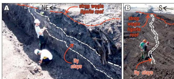
Ryc. 10. Poddarcie warstwy ilów w brzeżnej strefie ich występowania: A – o ok. 1 m na dystansie poniżej 10 m, B – o blisko 3 m na dystansie ok. 50 m
