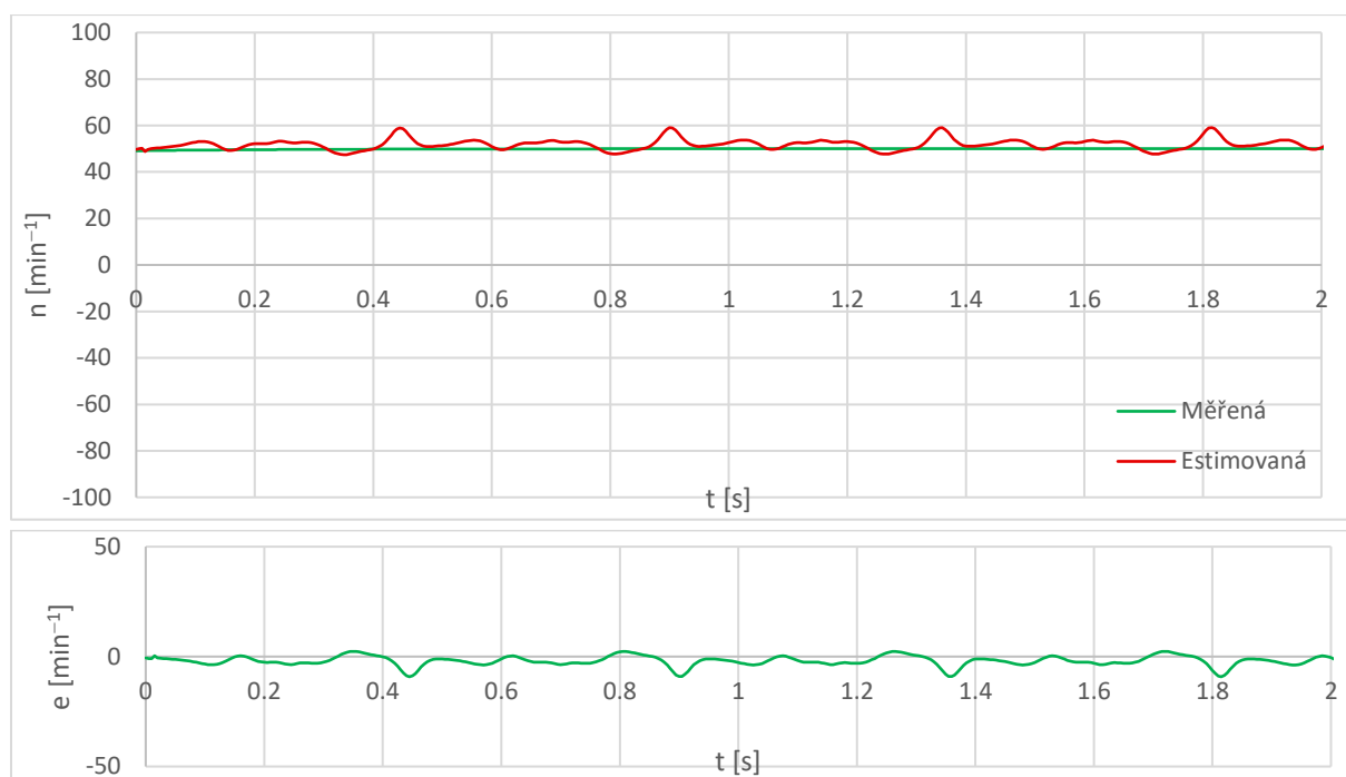
Obr. 4.6 Simulace ANNRF-MRAS: měřená a estimovaná rychlost motoru, zatížení pro 50 \text{ min}^{-1} , 20 \% M_n
