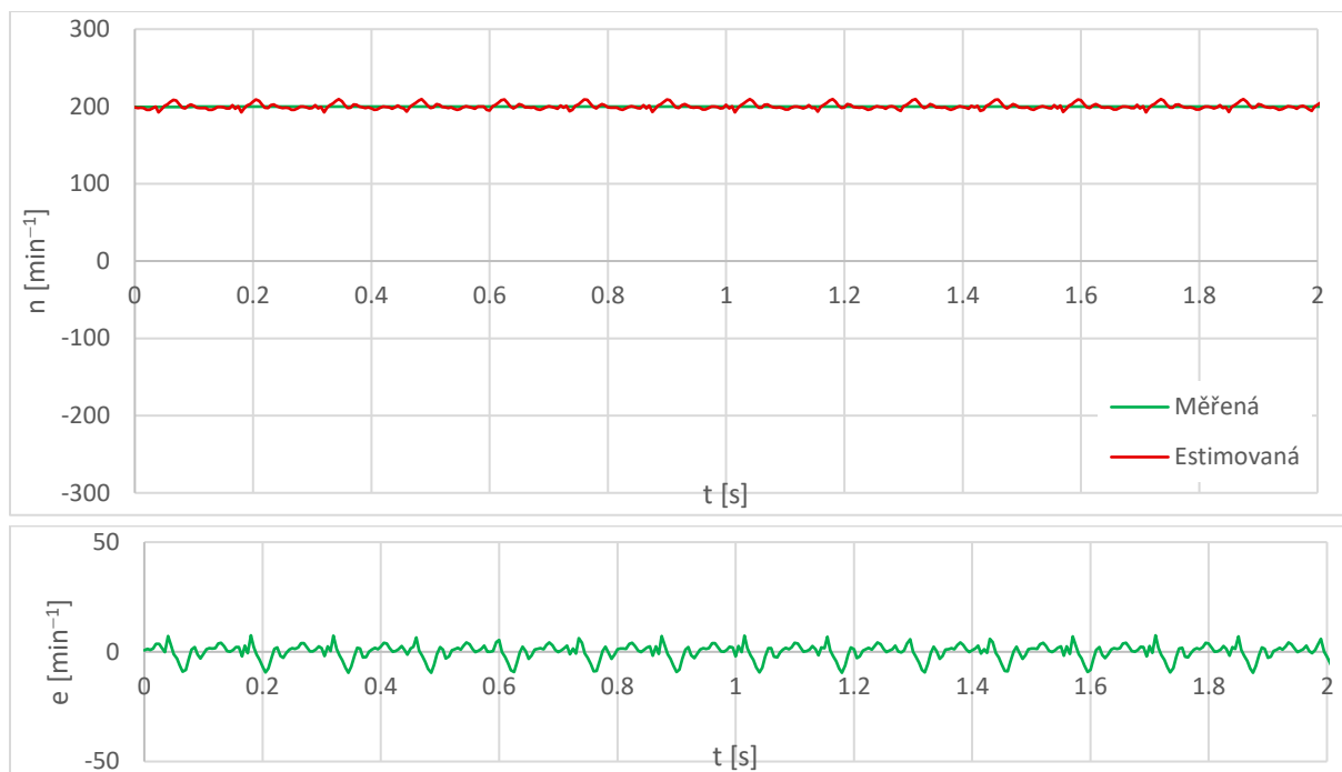
Obr. 4.2 Simulace ANN-EST: měřená a estimovaná rychlost motoru, zatížení pro 200 \text{ min}^{-1} , 20 \% M_n
