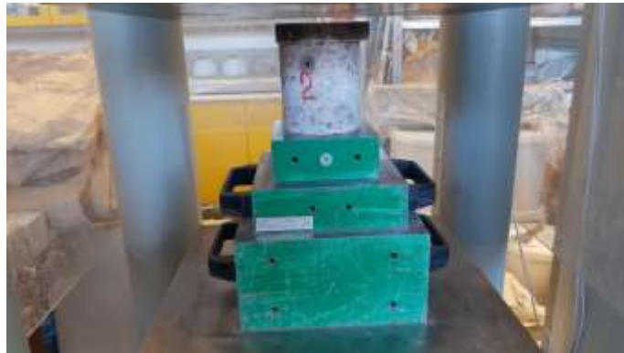
Obrázok 35 - Vzorka pripravená na skúšku pevnosti v tlaku [autor]
