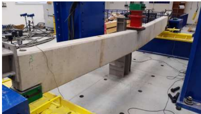
Obrázok 2 – Zaťažovanie železobetónového nosníka v skúšobnom lise [autor]
