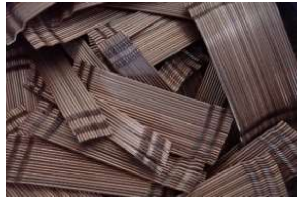
Obrázok 7 - Oceľové drôtičky s dvojitém koncovým ohybom a lepeným zväzkovaním [15]
