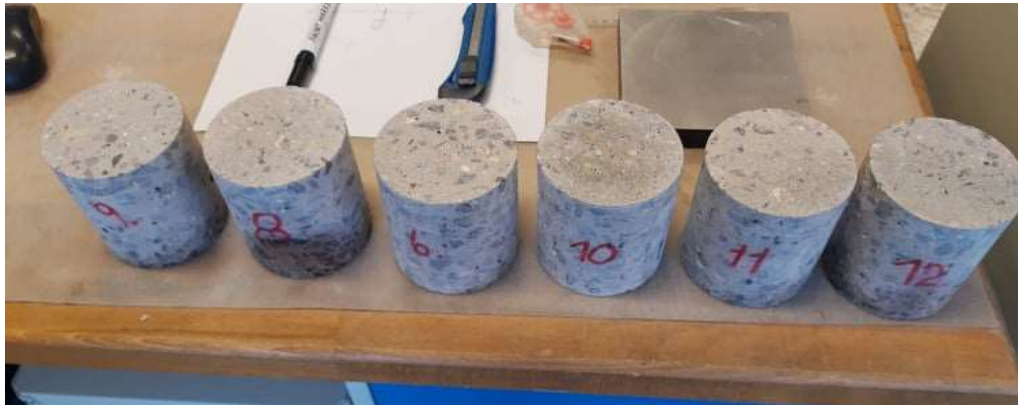
Obrázok 29 - Príprava vzoriek na skúšku pevnosti v tlaku [autor]
