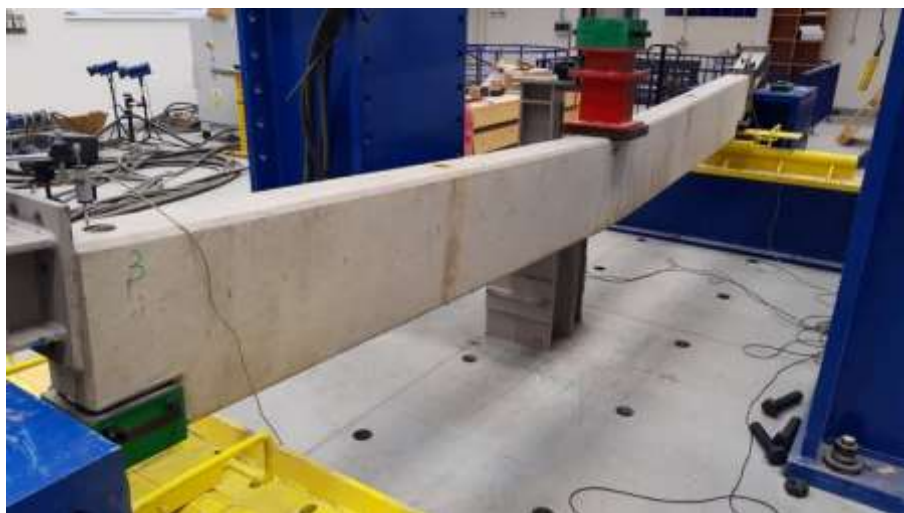
Obrázok 24 - Statická zaťažovacia skúška [autor]
