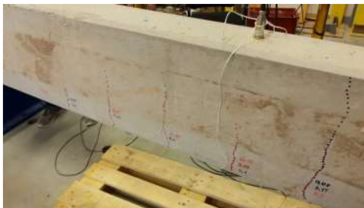
Obrázok 23 - Zaznačovanie trhlín na nosníku [autor]
