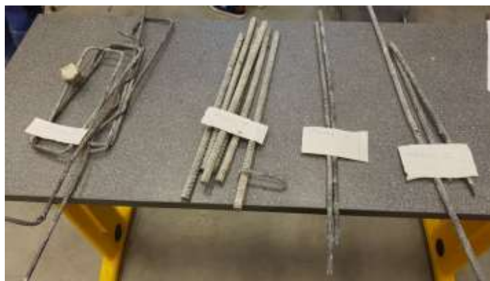
Obrázok 39 - Príprava vzoriek výstuže [autor]
