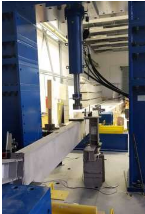
Obrázok 28 - Uloženie nosníka v skúšobnom lise [autor]
