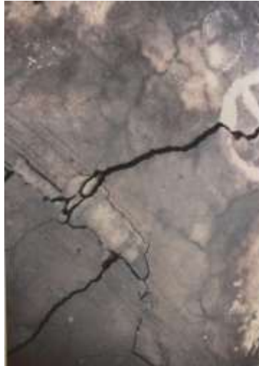
Obrázok 12 - Makrotrhliny spôsobené alkalicko kremičitou reakciou [19]
