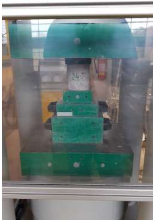
Obrázok 19 - skúška pevnosti v tlaku na jadrových vývrtoch [autor]
