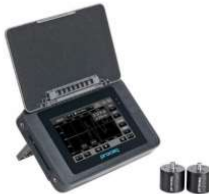
Obrázok 13 - Ultrazvukový prístroj Pundit PL-200 [32]
