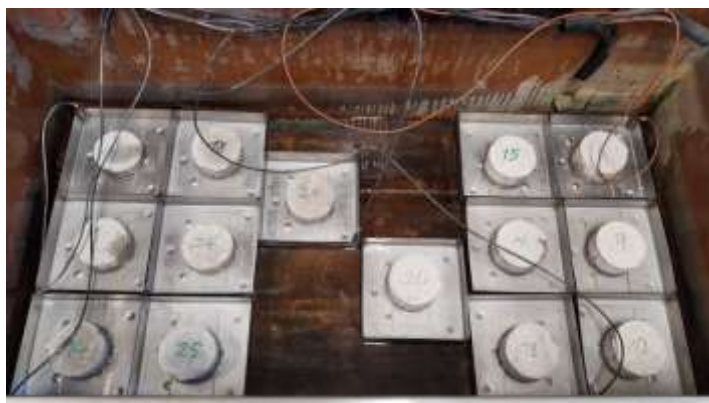
Obrázok 21 Vzorky uložené na skúšku CHRL [autor]
