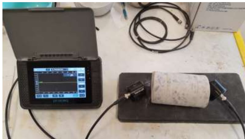
Obrázok 47 - Príprava vzorky na ultrazvukovú skúšku [autor]
