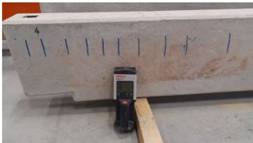
Obrázok 30 - Lokalizácia výstuže elektromagnetickým indikátorom [autor]
