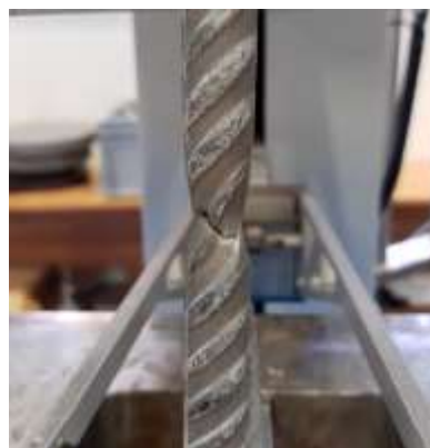
Obrázok 40 - Deformácia výstuže po prevedení skúšky [autor]
