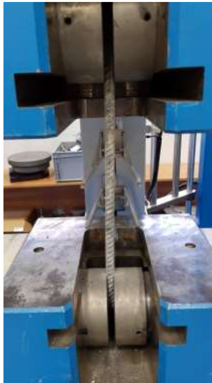
Obrázok 20 - Skúška pevnosti výstuže [autor]
