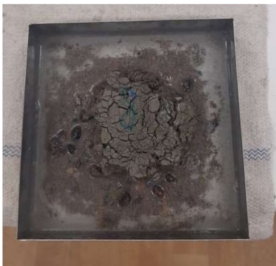
Obrázok 48 - Vyradená vzorka zo skúšky CHRL [autor]
