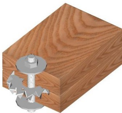
Obrázek 2-24. Ukázka spoje s ozubeným hmoždíkem typu „Bulldog“ a svorníkem. [13]
