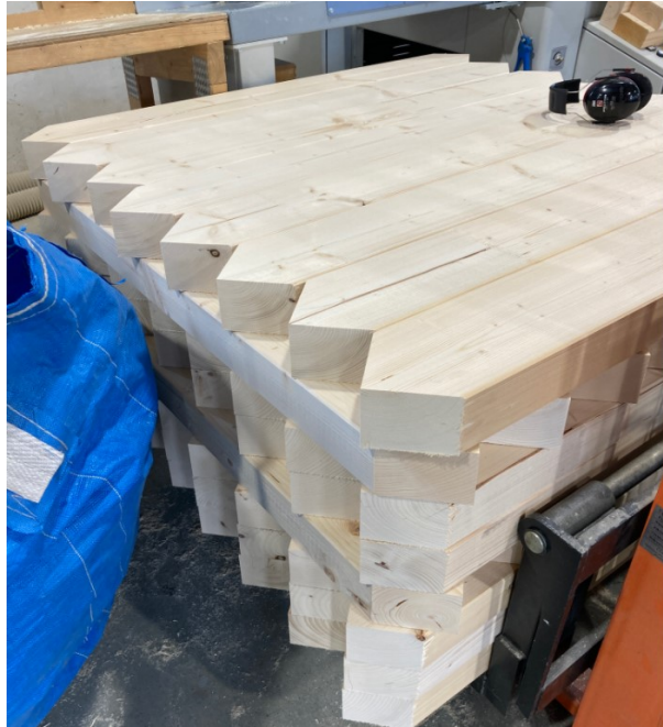
Obrázek 2-21. Jednotlivé pruty vazníku vytvořené na automatických pilách. Foto vlastní z návštěvy firmy [12].
