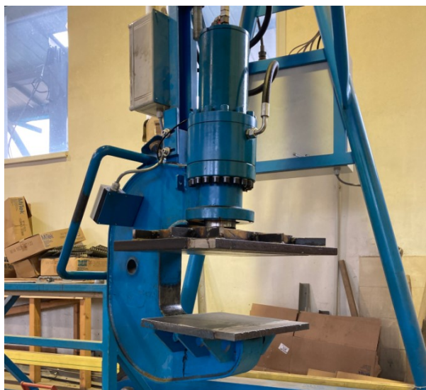
Obrázek 2-20. Pohyblivý hydraulický lis pro lisování ocelových desek do dřevěných prutů. Foto vlastní z návštěvy firmy [12].
