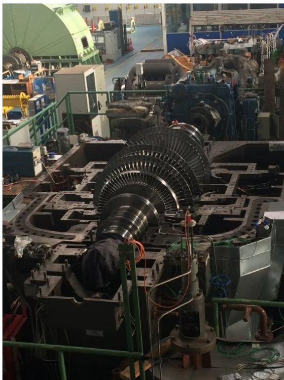
Obr. č. 1—1 Experimentální parní turbína 10 MW [Doosan Škoda Power]
