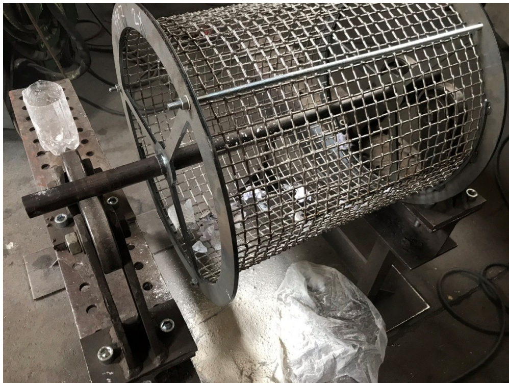
Obrázek 37 Zkouška třídění ve zmenšeném prototypu bubnu
