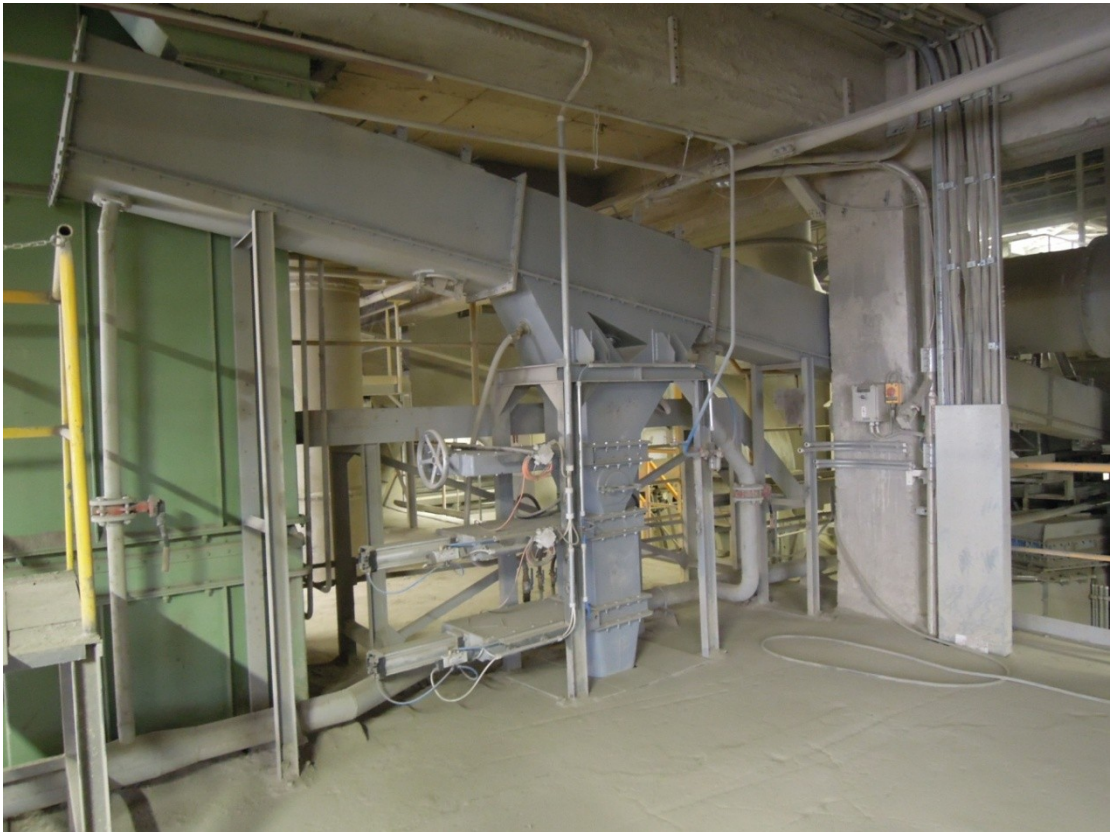
Obrázek 5 Pneumatický gravitační třídič v dopravní lince cementu
