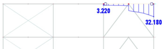
Obrázek 5-28. Maximální normálová tahová síla N_{t,d} na stropním nosníku ST4.A20.
